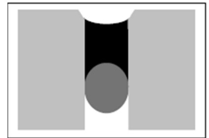
Een verdiept voegontwerp beschermt de kit tegen mechanische belasting.
